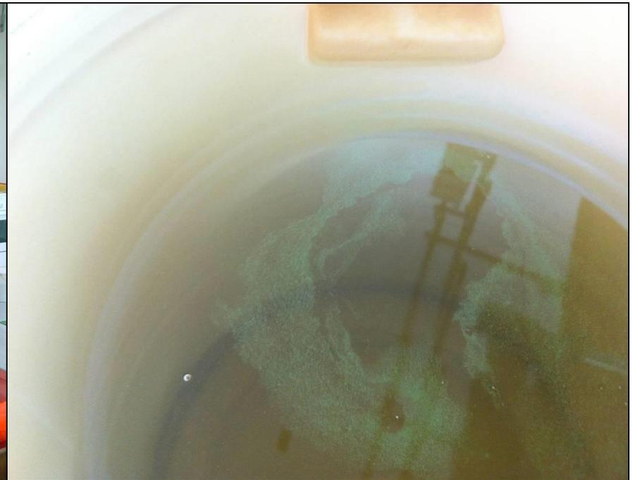
Im Batchversuch wurde Gesamtphosphor um ca. 80 % und Gelöstphosphor um > 90 % reduziert
