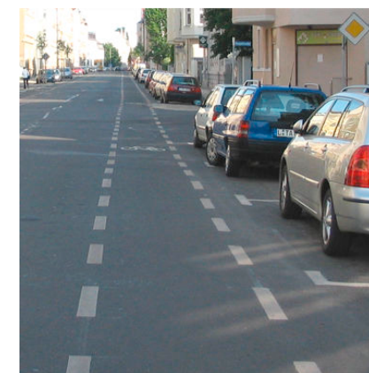
Sicherheitstrennstreifen bei Schutzstreifen
